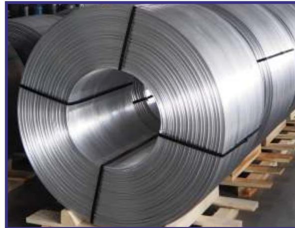
Катанка из алюминиевого сплава КАС АД00 используется для изготовления полуфабрикатов (листов, лент, полос, плит, профилей, панелей, прутков, труб, проволоки, штамповок и поковок) методом горячей или холодной деформации.
