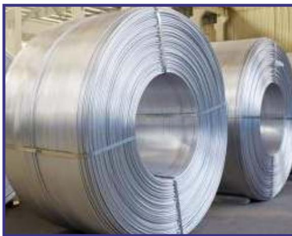
Катанка алюминиевая марок А5Е – ПТ, А5Е – Т1, А5Е – Т2 по ГОСТ 13843-2019 диаметрами 9,5; 12,7 мм, предназначенная для изготовления проволоки и других электротехнических целей.
