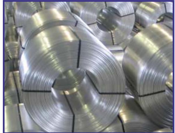
По своим эксплуатационным характеристикам кабели с токопроводящими жилами из алюминиевых сплавов 8000 серии не уступают традиционно применяемым проводам с медными жилами и имеют ряд существенных преимуществ:
