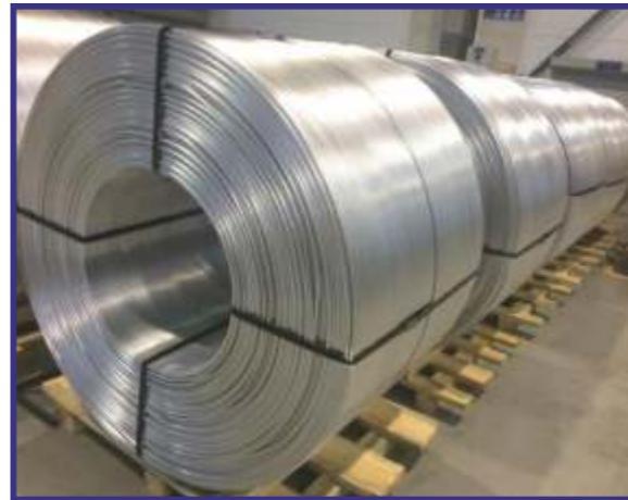
Катанка из алюминиевого сплава марки SvAK5, диаметром 9,5 мм, изготовленная в соответствии с ТУ 1712-003-91679523-2015 (ГОСТ 4784-97), применяется для изготовления сварочной проволоки.
